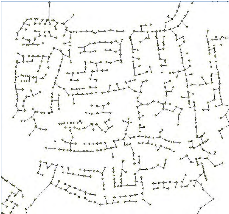
Abbildung 22: Spannbaum als kürzeste Verbindung zwischen den Hauskoordinaten
