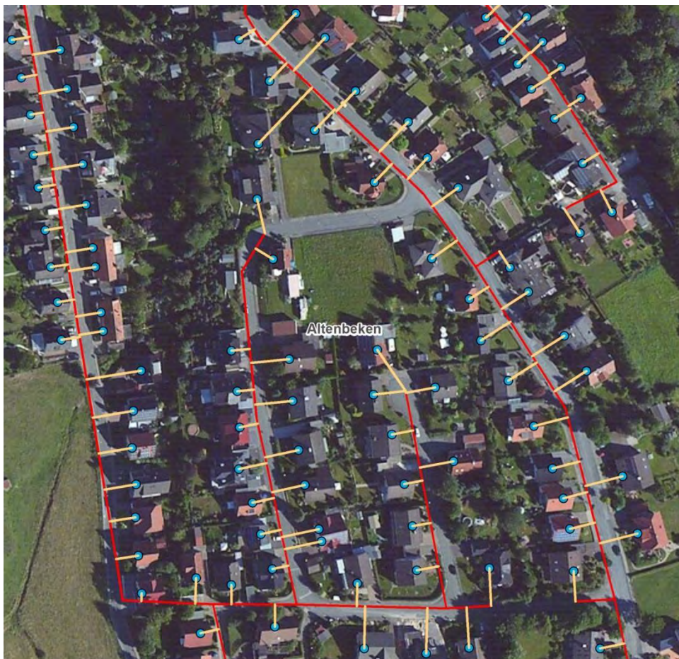
Abbildung 23: Ausschnitt aus dem hauskoordinatengenauen FTTB-Leerrohrkonzept
